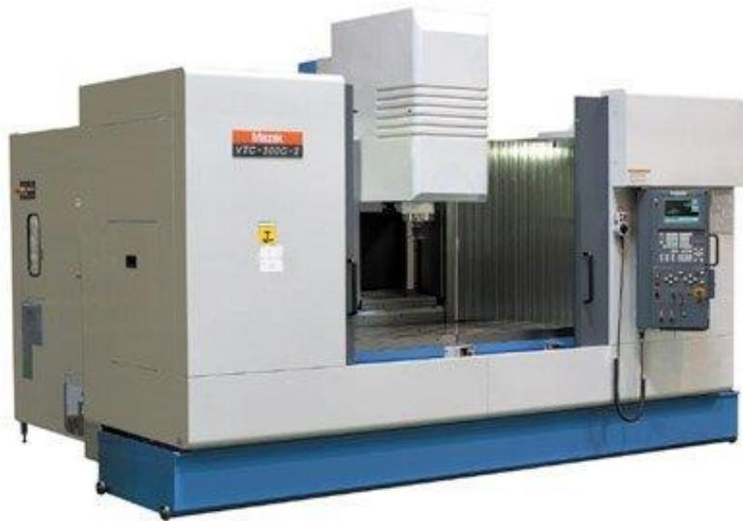
*Steuerung: CNC-Steuersystem MAZATROL PC Fusion 640*
