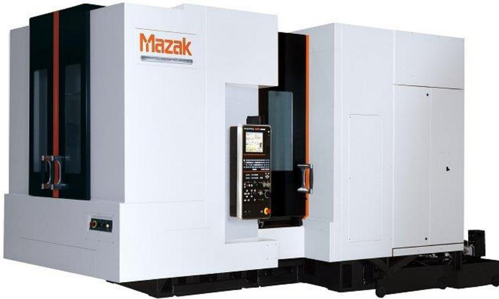
**Steuerung: CNC-Steuersystem MAZATROL MATRIX**
