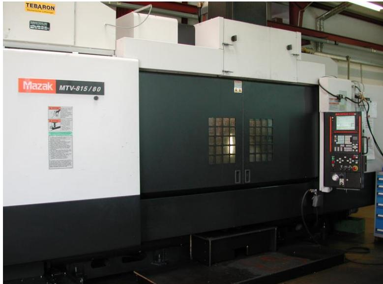
**Steuerung: CNC-Steuersystem MAZATROL PC Fusion 640**
