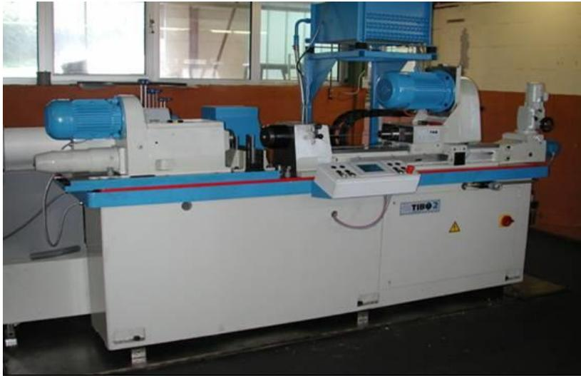
**Steuerung : Siemens Touch Panel mit TIBO Bohrprogramm (einfache Ausführung)**
