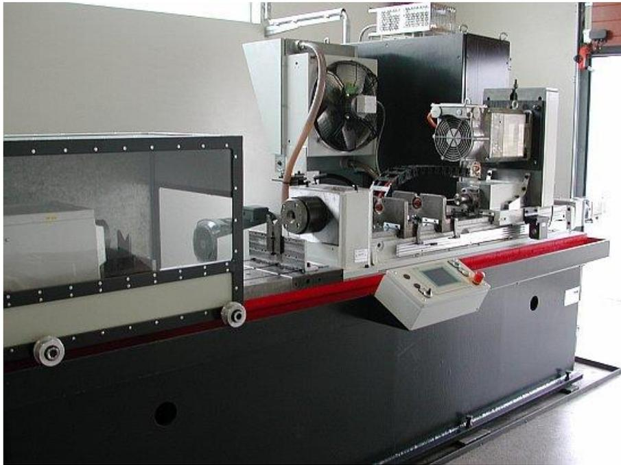
**Steuerung: Siemens Touch Panel mit TIBO Bohrprogramm (Sonderausführung mit einstellbarem Anbohrvorschub und einer zweiten möglichen Bohrtiefe)**
